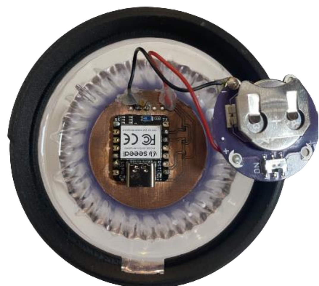
Abb. 2: Darstellung des PCB-Design (Unterseite)
