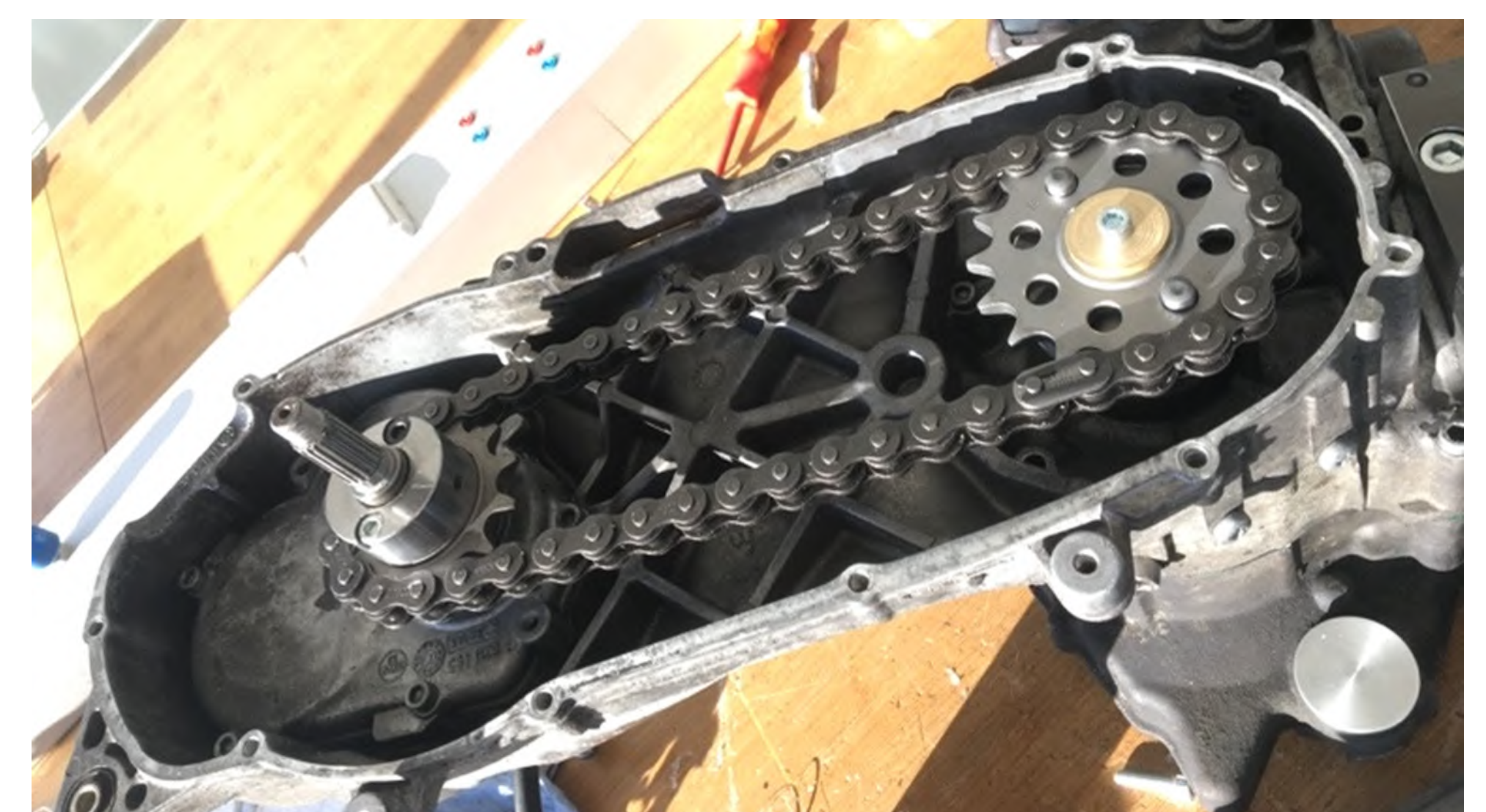
Kettenverlauf in Fahrtrichtung links
