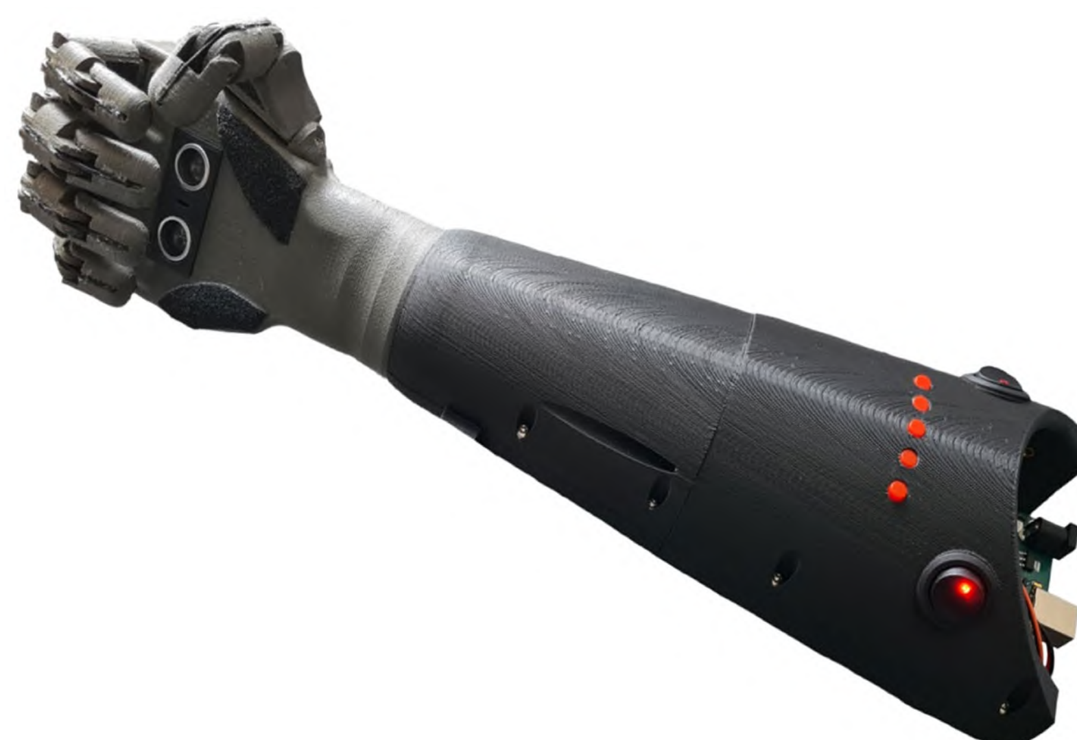
Fertige 3D gedruckte Unterarmprothese
