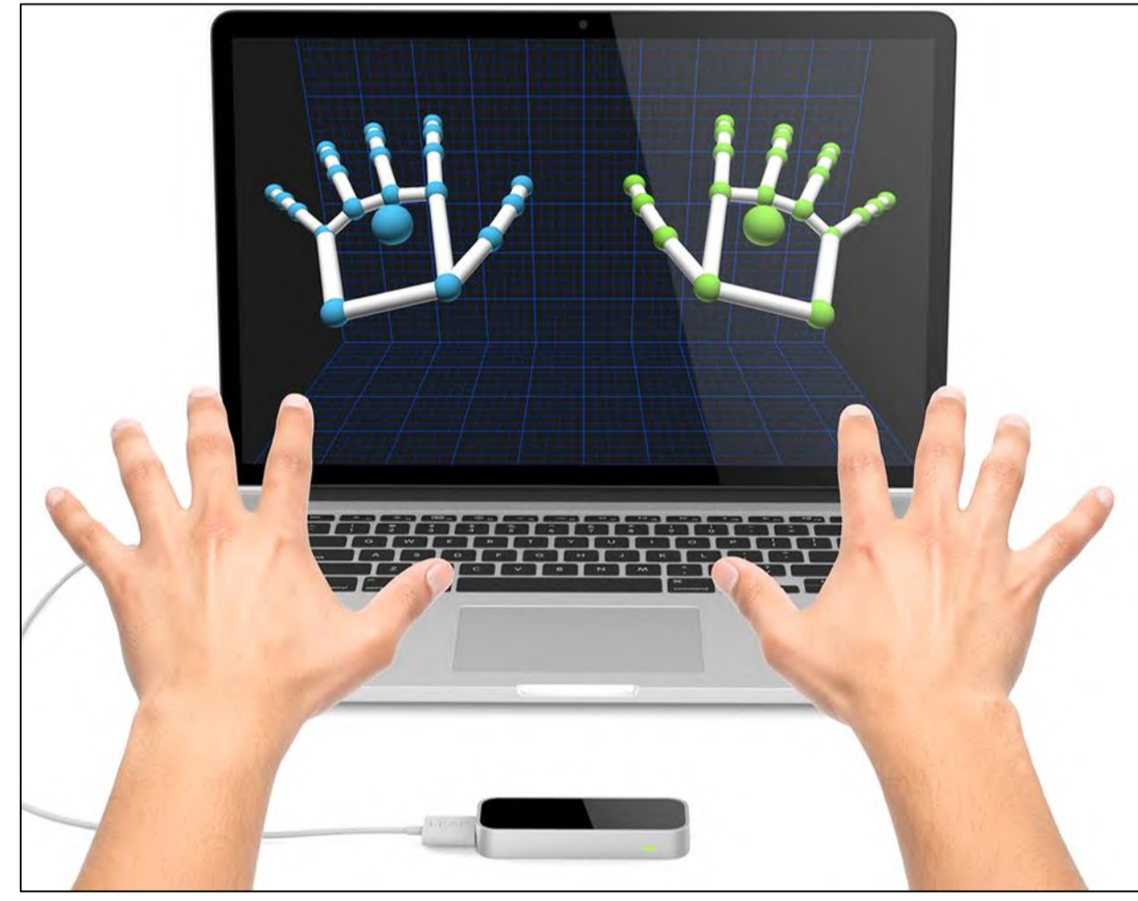
Linkes Bild: kollaborativer Roboter Cobotta von der Firma Denso Robotics Rechtes Bild: Leap Motion Controller Erkennung der Hände und visuelle Darstellung
