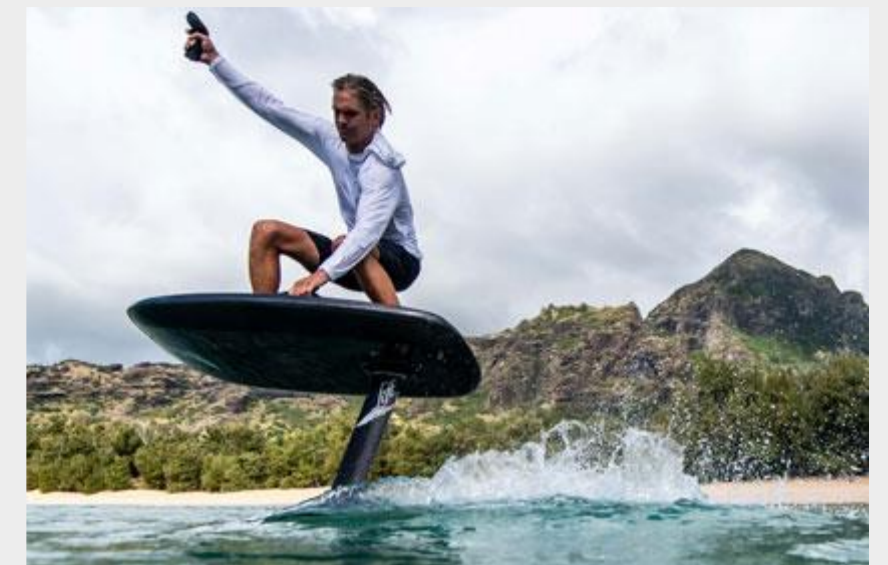
Surfboard mit einem Foil und elektrischem Antrieb [1]
